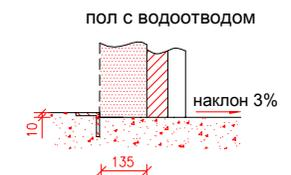
ВНИМАНИЕ: – Задние стороны простенков, перемычка и монтажные поверхности для пружин должны быть ровными и располагаться по линии. Проем также должен быть ровным и прямоугольным.
